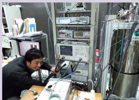
唐津さんと冷凍機（写真右端）。この冷凍機の中に MKID を 入れ、冷やした上で性能検査を行う
